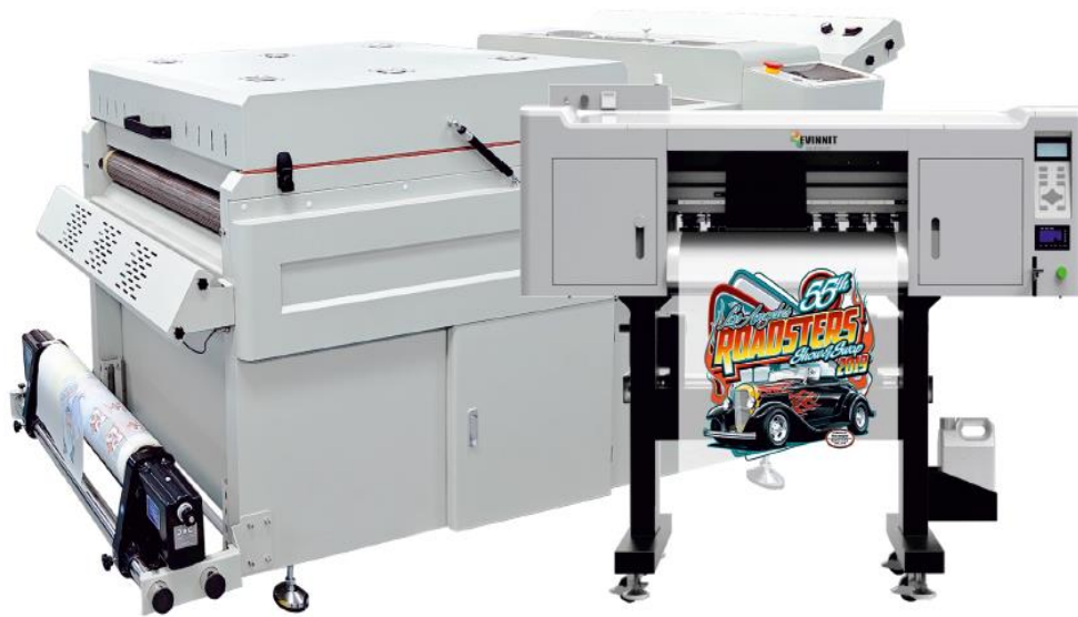
Εικόνα 1. Συνολική διάταξη εκτύπωσης μέσω της τεχνικής ψηφιακής εκτύπωσης DTF
